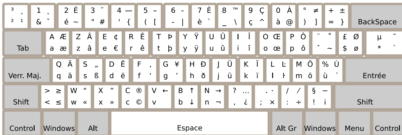
FIGURE 1 – Les symboles accessibles au clavier : sur une touche, la colonne de droite s’obtient en appuyant simultanément sur AltGr, la ligne du haut par la touche Shift. Ainsi, Æ s’obtient en faisant Shift + AltGr + A.
